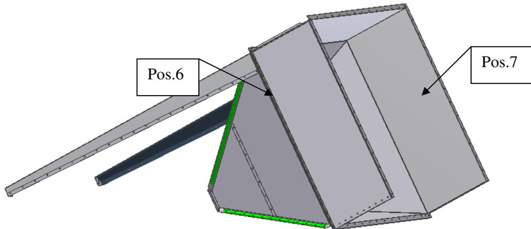
Anschließend wird die Konstruktion mit entsprechendem Gerät unter Beachtung der erforderlichen Sicherheitsvorschriften senkrecht gestellt und die restlichen **2 Stützen**, die letzte **Seitenwand (Pos.7)** und **das letzte Verstärkungsblech (Pos. 6)** sowie die **Abdeckungen (Pos. 8)** werden montiert.. Jetzt werden die **Schrägstreben (Pos. 4)** paarweise an den Stützen befestigt.
