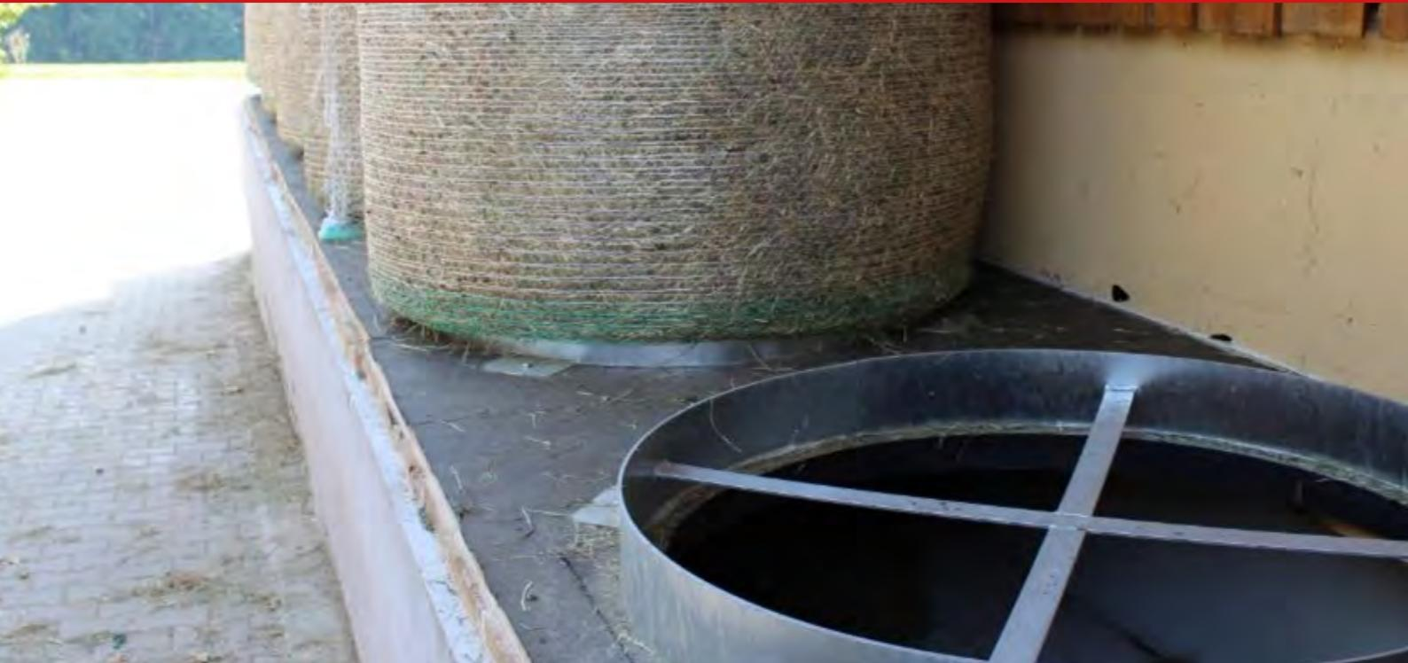
Mit der neuen Heuballentrocknung ist die Gewinnung von Heu in Form von Rundballen mit hoher Qualität garantiert. Die technische Durchlüftung sorgt für kürzere Trocknungszeiten, wodurch sich die Futterqualität verbessert.
