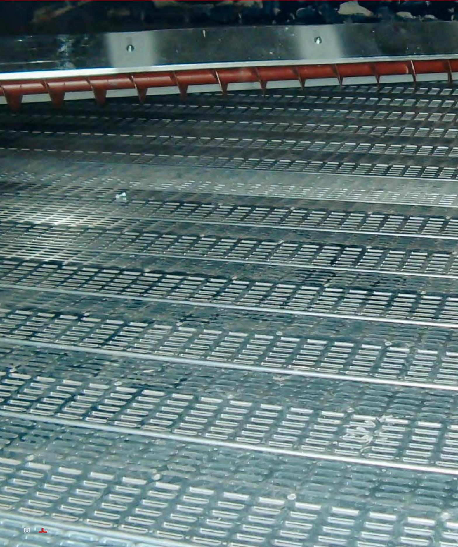
Rundsilobelüftung | Round silo ventilation | Ventilation des silos ronds | Вентиляция круглых силосов
