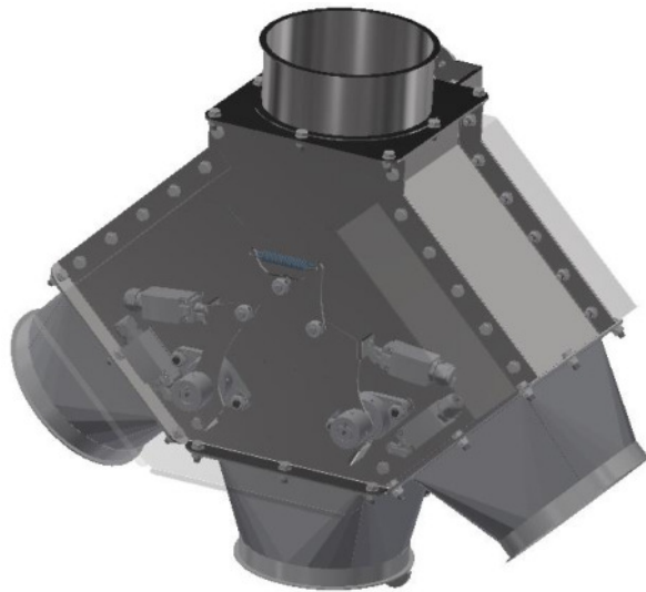
Abbildung 4: Rückseite mit Endschaltern als Positionsanzeige
