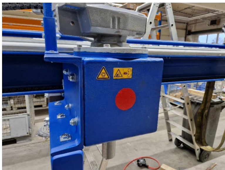
Bild 7: Montera den rödmarkerade omrörningsskruven vid den röda punkten.
