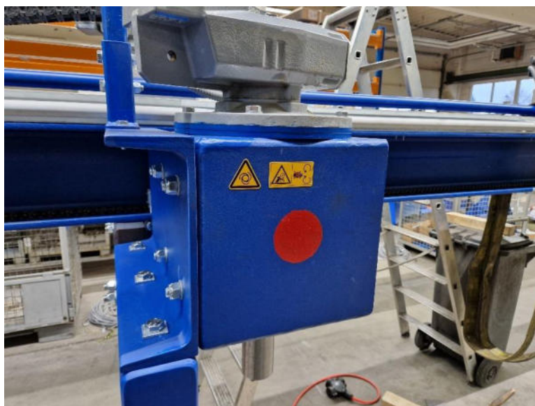
Рисунок 8: Закрепите шнек с красной отметкой на сторону каретки с красной отметкой
