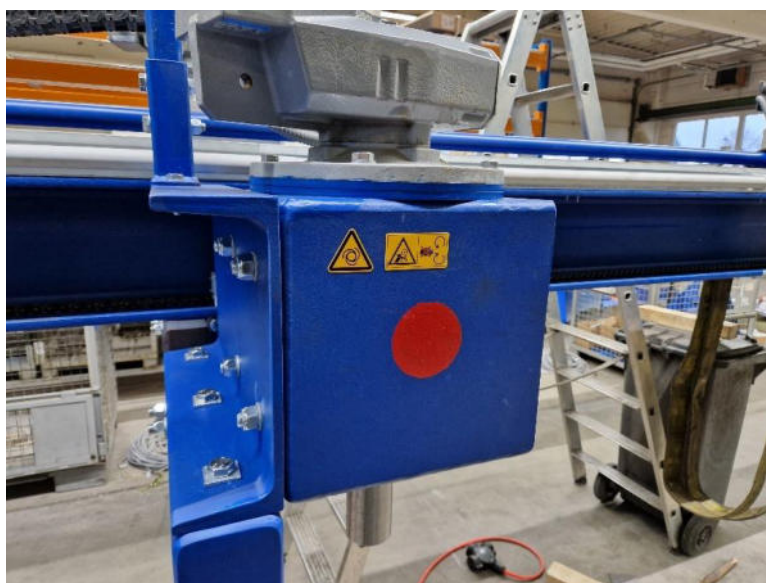
Représentation 11: Vissez la vis sans fin marquée en rouge sur le côté avec le point rouge.
