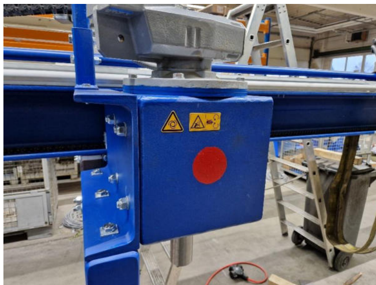
Figura 13: Enrosque el tornillo identificado con una marca roja en el lado correspondiente con el punto rojo.
