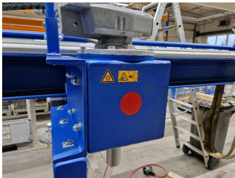
Représentation 11: Vissez la vis sans fin marquée en rouge sur le côté avec le point rouge.
