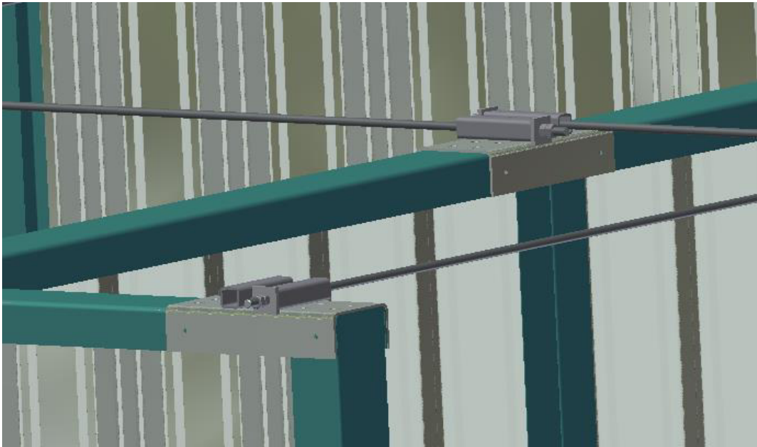
Photo 19 Construction du haubannage horizontal
