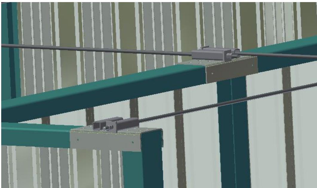
Bild 20 Einbau der waagrechten Abspannung
