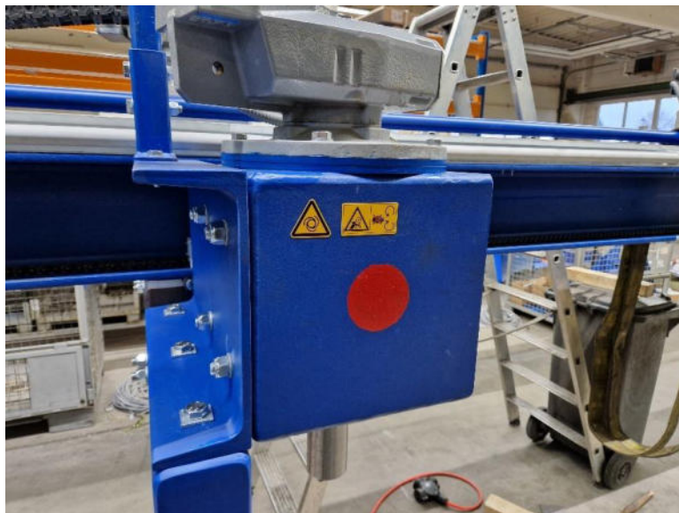
Рисунок 8: Закрепите шнек с красной отметкой на сторону каретки с красной отметкой
