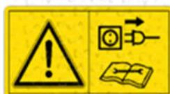
Vor Reinigungs-, Wartungs- und Reparaturarbeiten Motor abstellen, Netzstecker ziehen oder Hauptschalter in Nullstellung mit Vorhängeschloss sichern!
