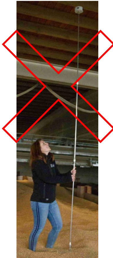
Abbildung 22: Negativbeispiel. Messstäbe immer zerlegen.
