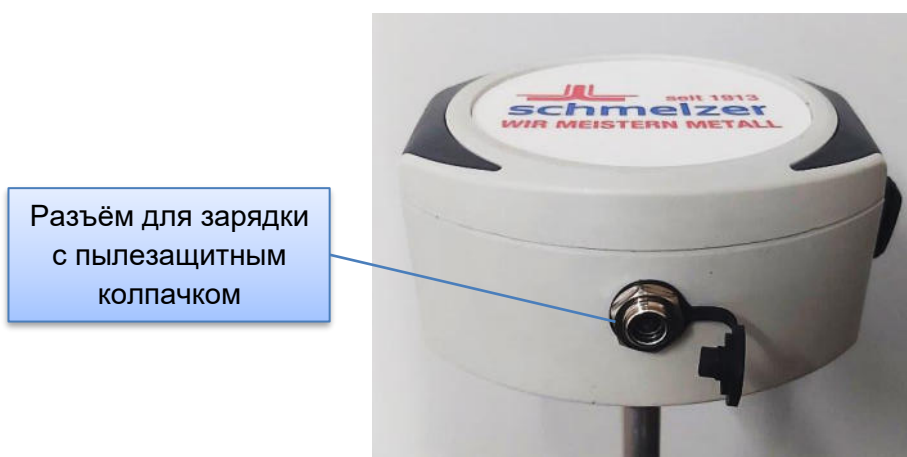
Рисунок 8: Разъём для зарядки постоянным током
