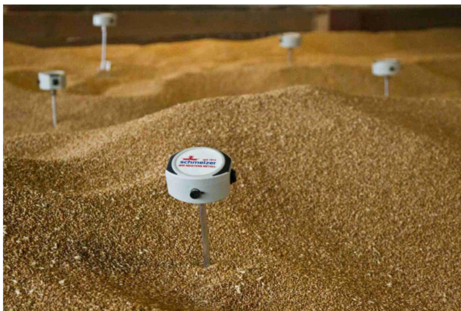
Рисунок 11: Измерительные штанги в пшенице.
