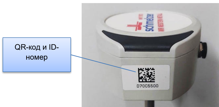
Рисунок 9: ID-номер и QR-код на измерительной штанге
