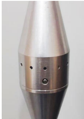
Abbildung 18: Arretierung muss ganz "herausspringen".
