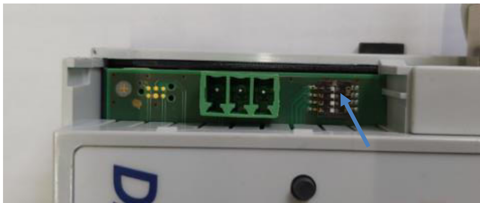
Abbildung 6: DIP Schalter der Datensammelbox. (Einstellung LAN).
