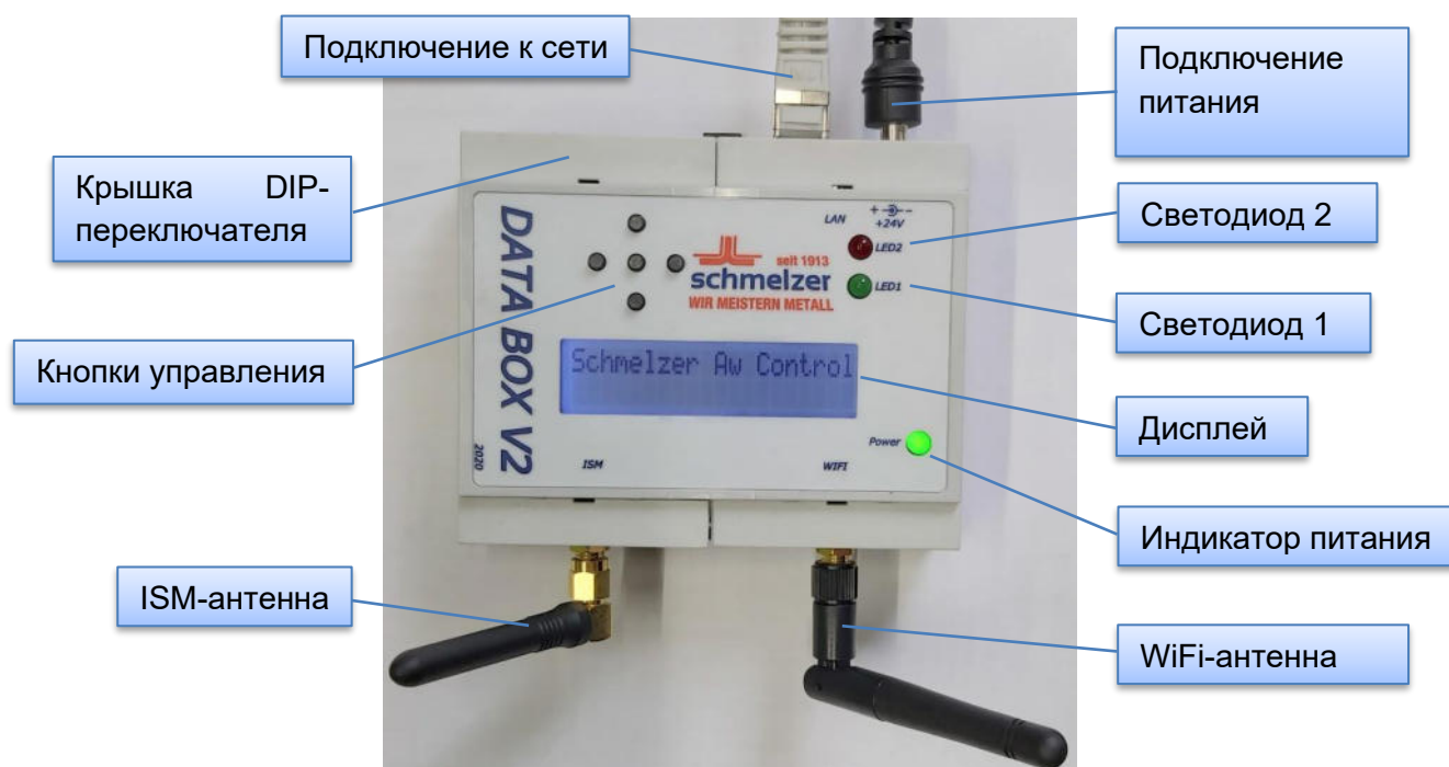
Рисунок 4: Подключённая базовая станция (с помощью сетевого кабеля).
