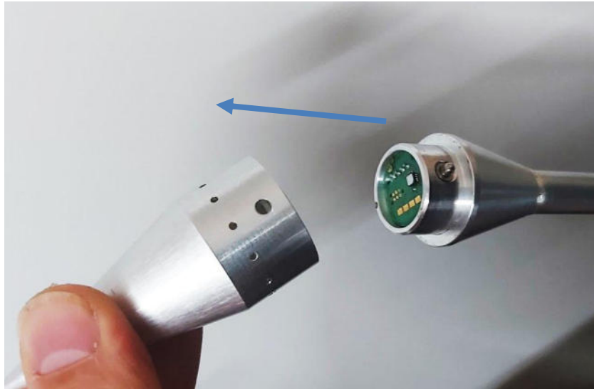
Représentation 14: Retrait de la pointe de mesure
