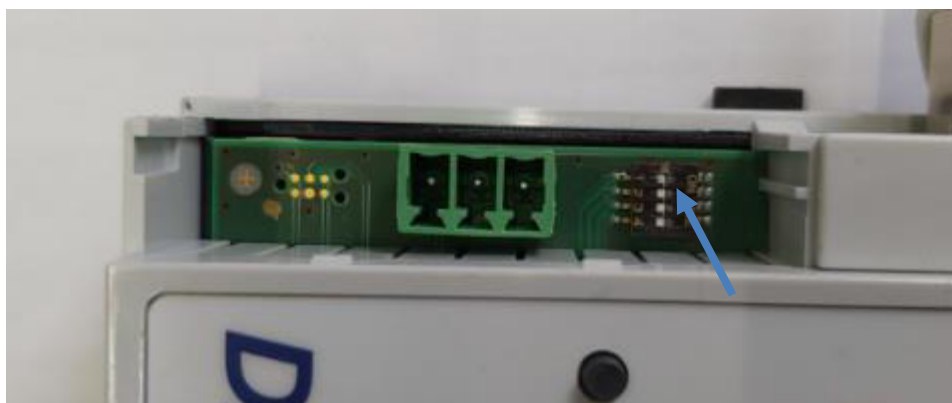
Рисунок 6: DIP-переключатель блока базовой станции. (Настройка локальной сети)
