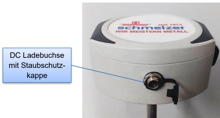
Abbildung 8: Offene DC Ladebuchse.
