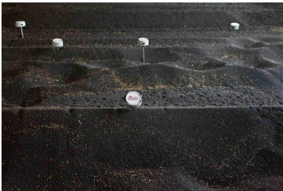
Рисунок 10: Измерительные штанги в рапсе.
