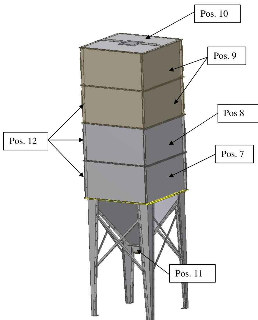
Les pièces de couvercle (pos. 10) et le tiroir d'évacuation (pos. 11) sont fixés en dernier l
