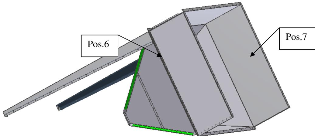
Anschließend wird die Konstruktion mit entsprechendem Gerät unter Beachtung der erforderlichen Sicherheitsvorschriften senkrecht gestellt und die restlichen **2 Stützen**, die letzte **Seitenwand (Pos.7)** und **das letzte Verstärkungsblech (Pos. 6)** montiert werden.
