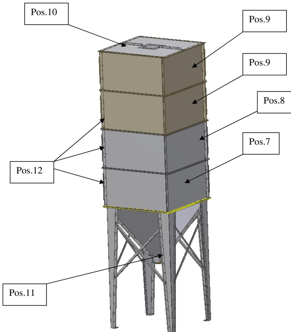
Als Letztes werden die **Deckelteile (Pos. 10)** und der **Auslaufschieber (Pos. 11)** angebracht.
