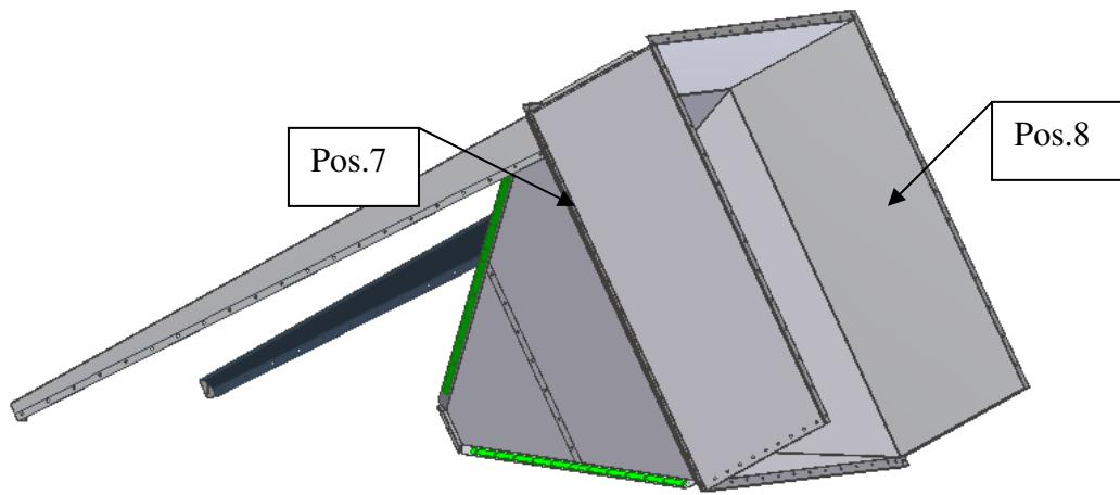
Anschließend wird die Konstruktion mit entsprechendem Gerät unter Beachtung der erforderlichen Sicherheitsvorschriften senkrecht gestellt und die restlichen **2 Stützen**, die letzte **Seitenwand (Pos.8)** und **das letzte Verstärkungsblech (Pos. 7)** montiert werden.
