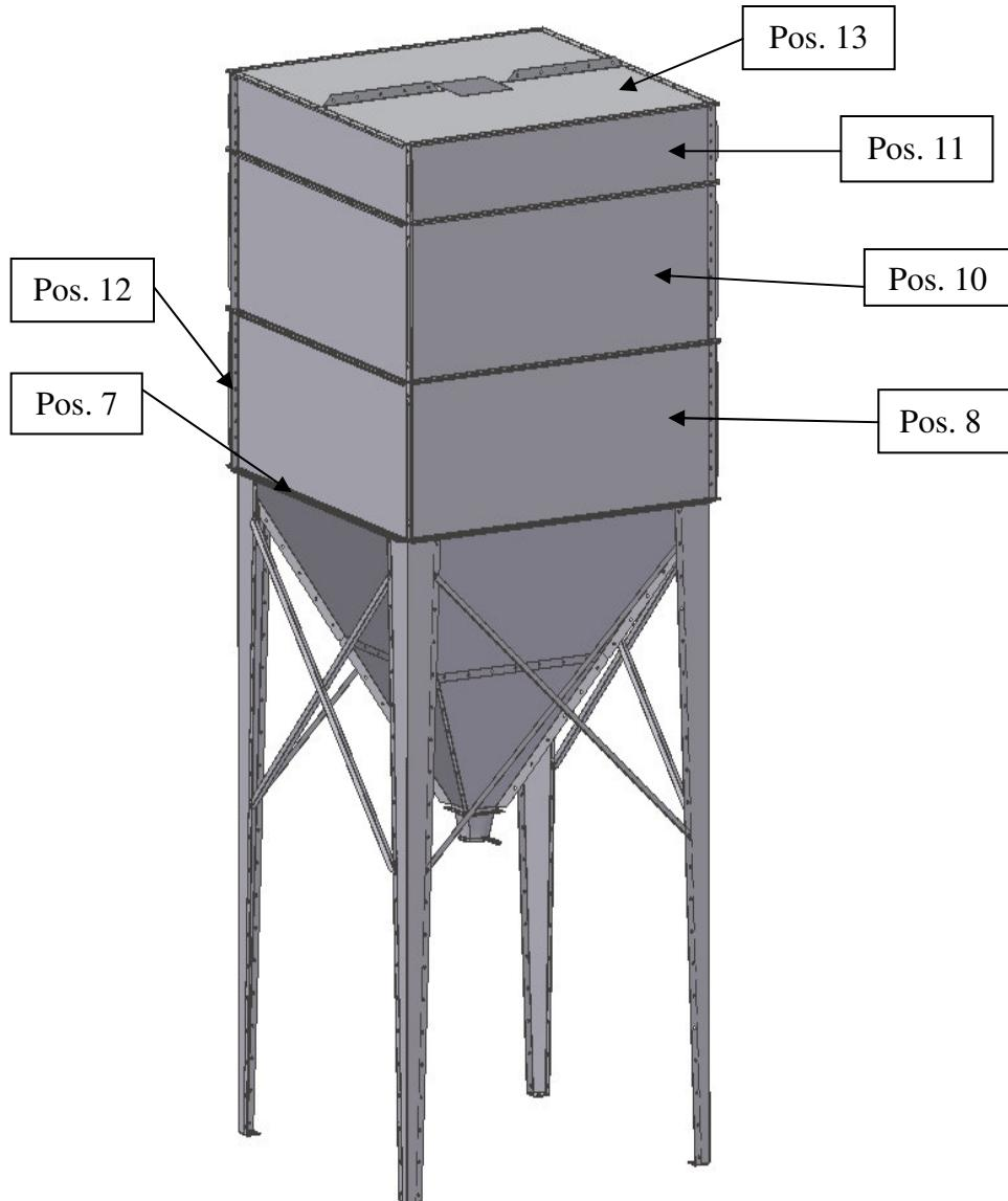
Als Letztes werden die **Deckelteile (Pos. 13)** und der **Auslaufschieber (Pos. 14)** angebracht.
