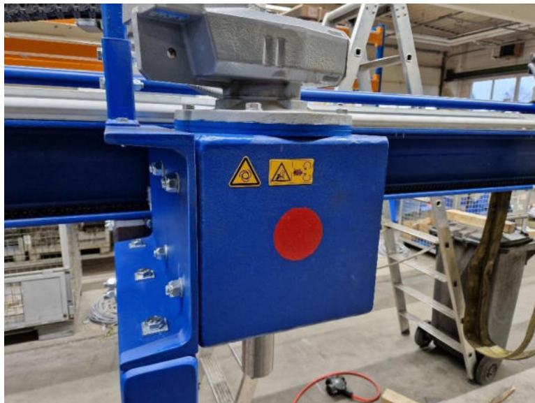
Abbildung 13: Schrauben Sie die rot markierte Schnecke an die Seite mit dem roten Punkt.
