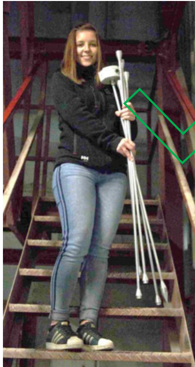
Représentation 21: Toujours démonter les tiges de mesure pour les transporter. Si possible les ranger dans leur carton d'origine.
