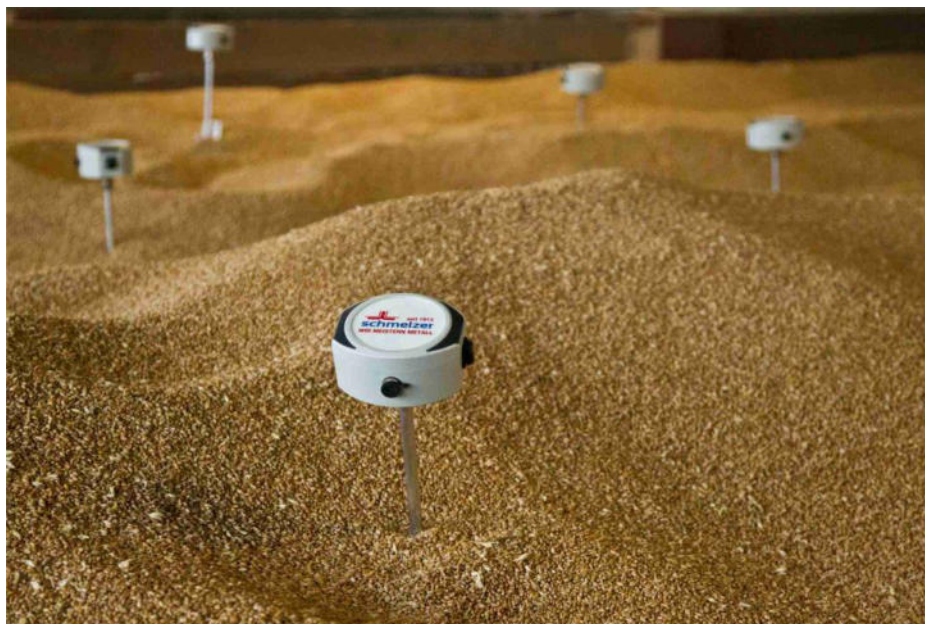
Représentation 9: Têtes de mesure dans le blé
