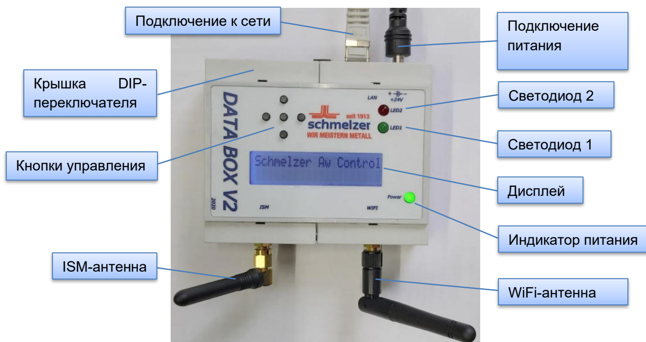
Рисунок 4: Подключённая базовая станция (с помощью сетевого кабеля).
