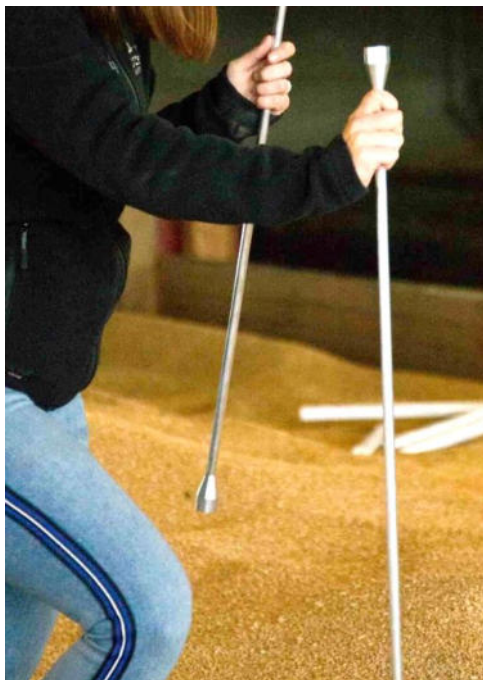
Représentation 17: Insertion de l'extension avec la pointe dans le tas de grain
