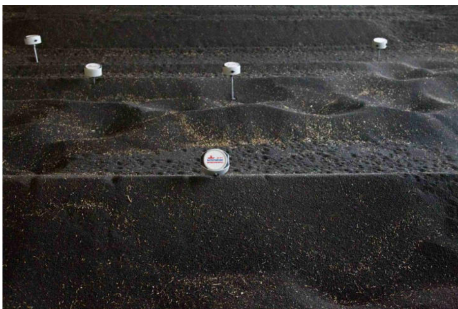
Représentation 8 : têtes de mesure dans le colza
