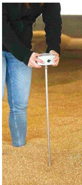
Рисунок 21: Измерительная головка должна располагаться всегда сверху.
