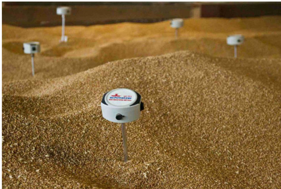
Abbildung 11: Messstäbe eingebracht in Weizen.
