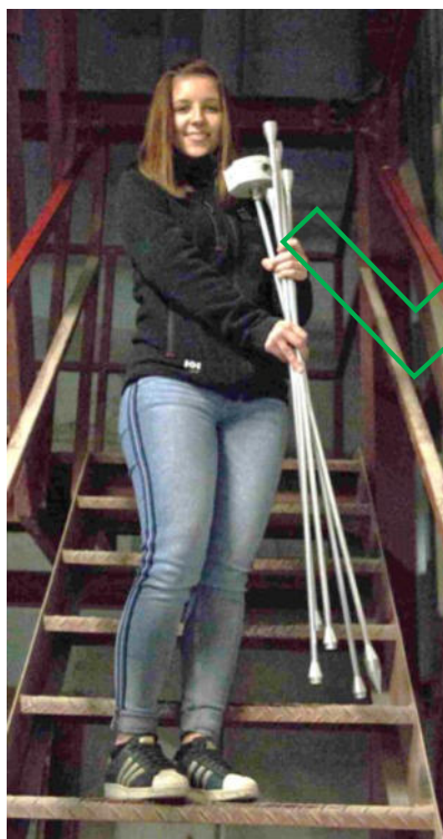
Рисунок 23: Всегда транспортируйте измерительные штанги в разобранном виде. Если можно, храните удлинители в транспортной коробке.
