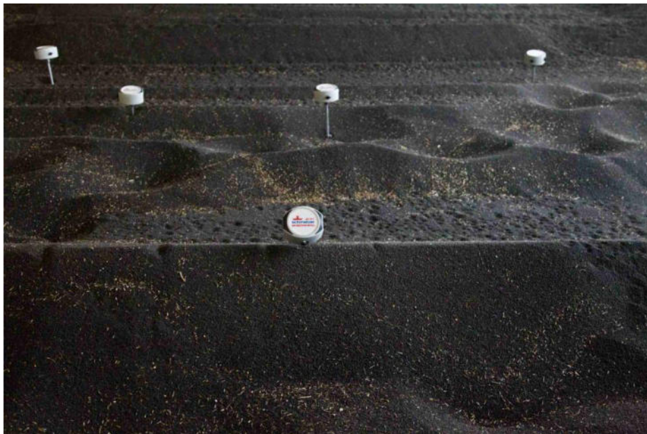
Abbildung 10: Messstäbe eingebracht in Raps.
