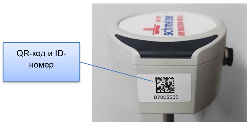
Рисунок 9: ID-номер и QR-код на измерительной штанге
