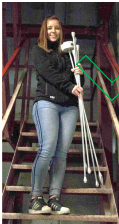
Abbildung 23: Messstäbe immer zerlegt transportieren. Wenn möglich, bitte die Verlängerung in den Versandkarton lagern.
