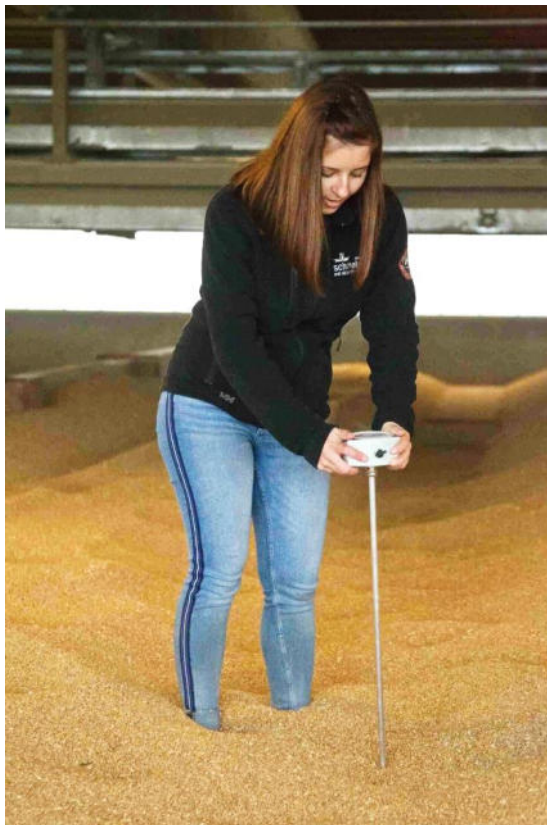
Représentation 11: Insérer la pointe de la tige de mesure dans le tas de matière
