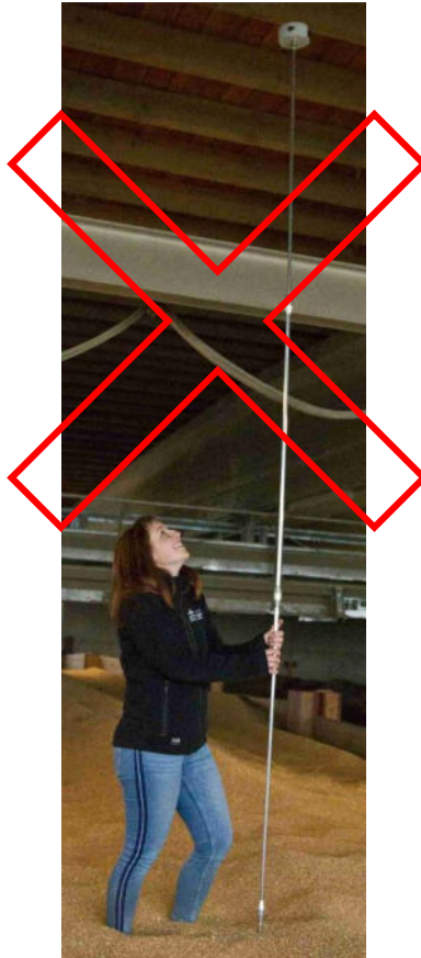
Représentation 20: Mauvais exemple – Il faut toujours démonter les tiges de mesure
