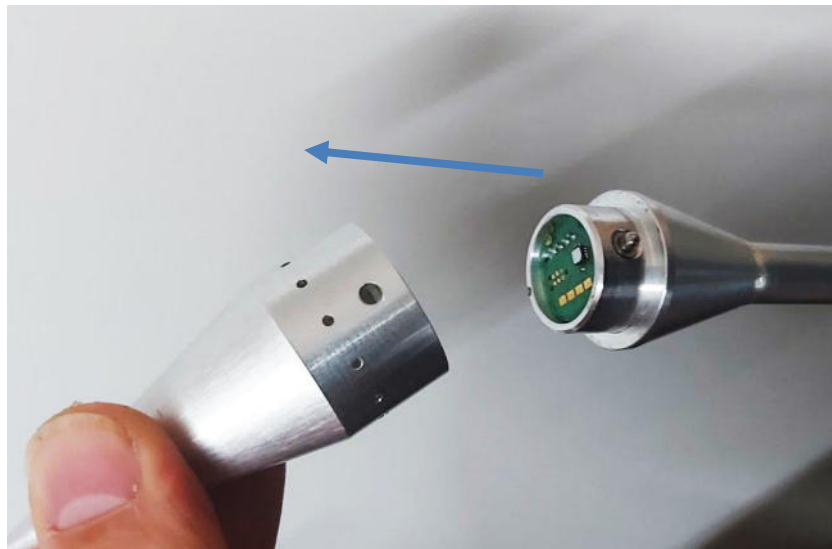
Abbildung 16: Abziehen der Messspitze
