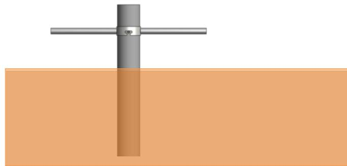
Вентилаторът се вкарва във вентилационната пика (с помощта на болтова връзка). Уплътнението е напълно автоматично. Обърнете внимание на въртенето на мотора след свързване на устройството към електрозахранването (в зависимост от конструкцията). То е означено. При свързване звезда-триъгълник има фазов преобразувател. Ако въртенето е в неправилна посока, то трябва да се промени.
