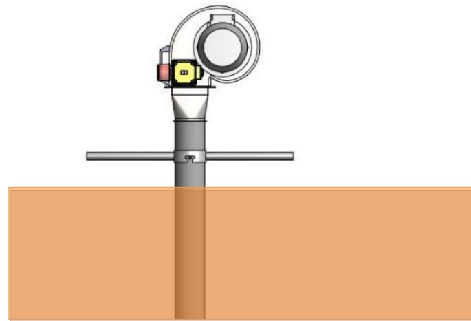
L'air va être poussé dans le tas afin de refroidir les céréales à une certaines température (Exception : Air-Lance peut également être utilisé en aspiration dans sa version standard). La durée de la ventilation dépend de la température, de l'humidité, de l'humidité de l'air et du type de céréales et doit être vérifiée avec des moyens appropriés. Vérifiez que de l'air frais est toujours à disposition lors de la ventilation.
