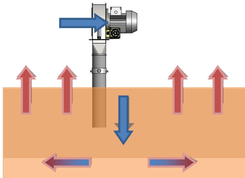
La lanza de aireación puede utilizarse para airear temporalmente cantidades medianas de grano almacenado en el suelo. La lanza debe introducirse en el grano lo más verticalmente posible.
