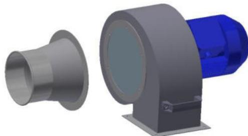
Visser maintenant la transition soufflerie sur le ventilateur avec les vis livrées.
