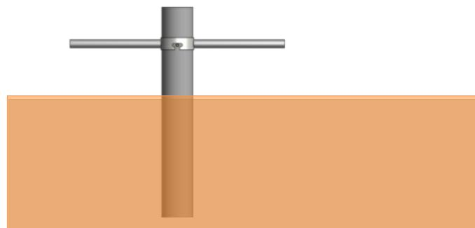
Das Gebläse wird (evtl. mit Hilfe des angeschraubten Übergangs) in den Belüftungsspeer gesteckt. Die Abdichtung erfolgt automatisch. Achten Sie nach Anstecken des Stromkabels auf die Drehrichtung des Motors (je nach Ausführung). Diese ist gekennzeichnet. In der Schalter-Stecker-Kombination ist ein Phasenwender. Sollte die Drehrichtung nicht stimmen, muss diese geändert werden.
