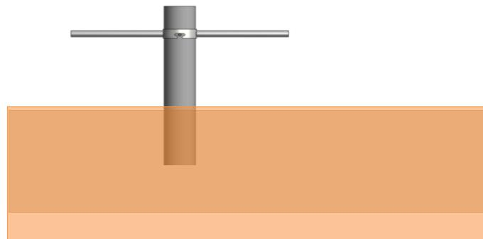
El ventilador se inserta en la lanza de ventilación (posiblemente con la ayuda del adaptador atornillado). El sellado es automático. Después de enchufar el cable a la corriente, preste atención al sentido de giro del motor (según la versión). Esto está etiquetado. En la combinación de interruptor y enchufe hay un inversor de fase. Si el sentido de giro no es correcto, debe cambiarse.
