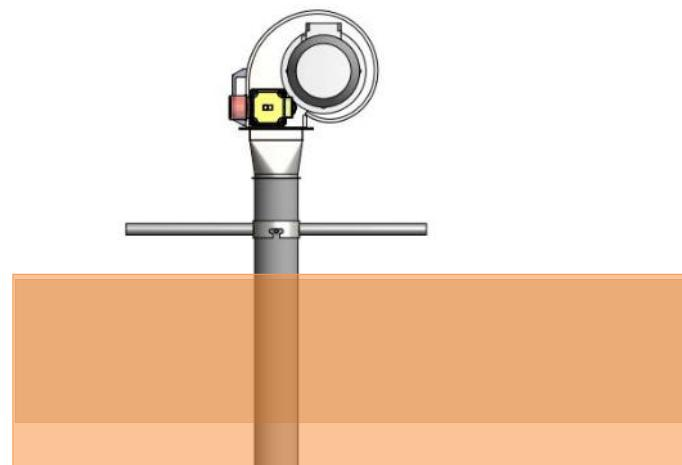
El aire se introduce a presión en la pila de grano (excepción: Air-Lance también puede utilizarse con aspiración en la versión estándar) para enfriar el grano a una temperatura adecuada. La duración de la ventilación depende de la temperatura, humedad, humedad relativa y tipo de grano, y debe ser supervisada con los medios adecuados. Asegúrese de que durante la ventilación siempre haya aire fresco disponible.
