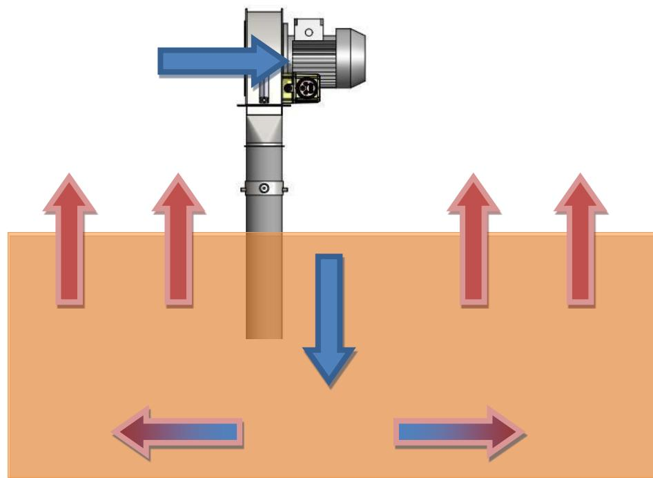
La vis de ventilation peut être utilisée pour la ventilation temporaire de petites quantités de céréales stockées au sol. La vis doit être placée le plus verticalement possible dans les céréales.
