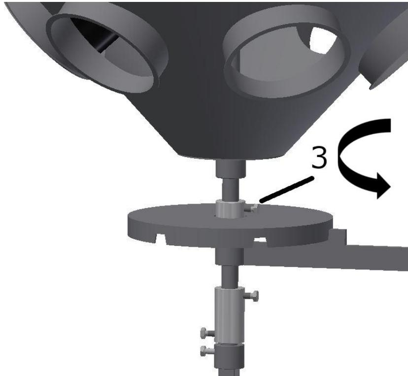
4. Drehen Sie nun das Innenrohr so, dass es über einen Auslauf steht. Drehen Sie den Drehkranz so, dass er an dem Fixierhebel einrastet.
