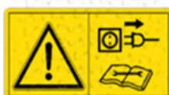
Перед проведением работ по чистке, техническому обслуживанию и ремонту выключите двигатель, вытащите вилку сетевого шнура или закрепите главный выключатель в нулевом положении с помощью замка!
