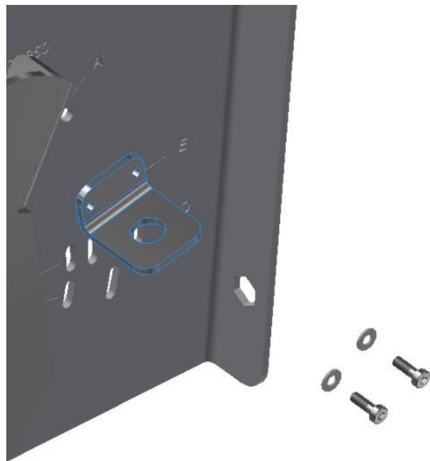
Прикрутите кронштейн концевого выключателя в соответствующее положение с помощью прилагаемых винтов.
