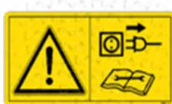
Vor Reinigungs-, Wartungs- und Reparaturarbeiten Motor abstellen, Netzstecker ziehen oder Hauptschalter in Nullstellung mit Vorhängeschloss sichern!
