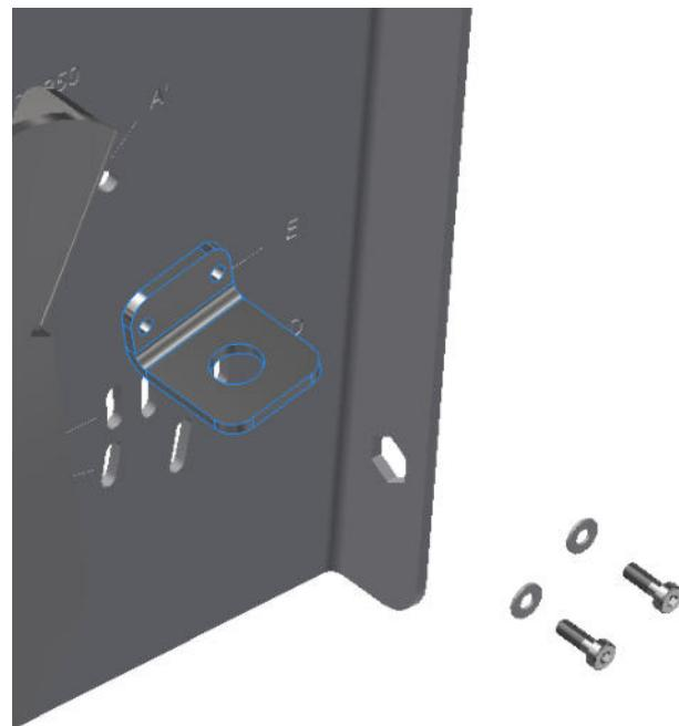
Schrauben Sie den Endschalterwinkel mit den mitgelieferten Schrauben an die entsprechende Position.
