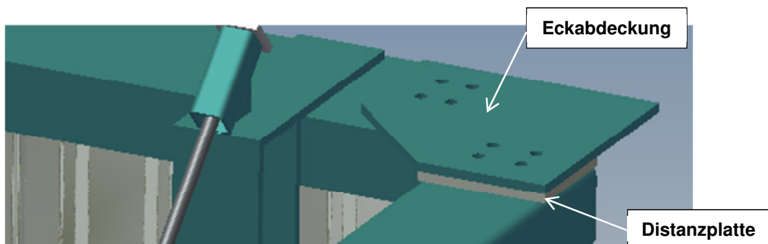
Bild 15 Wandecke mit Distanzplatte zum Höhenausgleich
