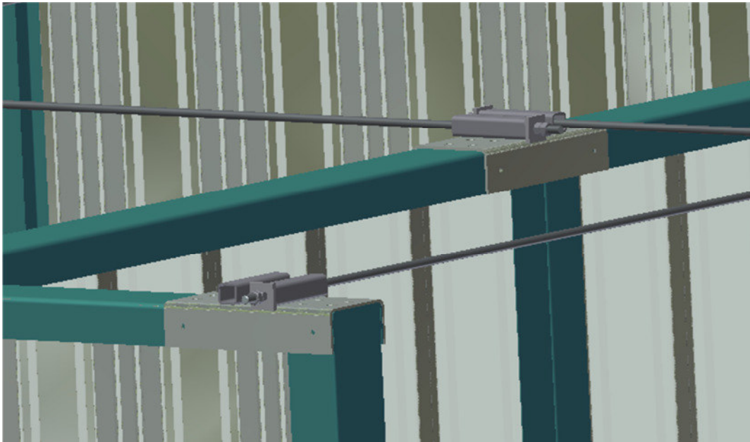
Photo 20 Construction de l'haubannage horizontal
