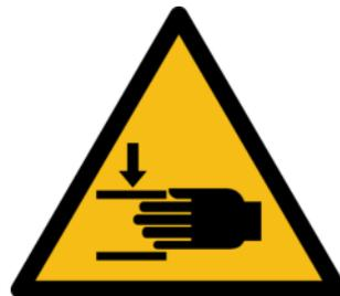
**Es muss unbedingt sichergestellt werden, dass vor und nach der Zellradschleuse vor der Inbetriebnahme Anlagenteile verbaut sind, die es unmöglich machen während des Betriebs hineinzufassen. Wenn ein freier Auslauf gewünscht ist, ist trotzdem ein Rohrstück mit der Mindestlänge von einem Meter anzubringen z.B. Art. Nr. 4010014015682.**
