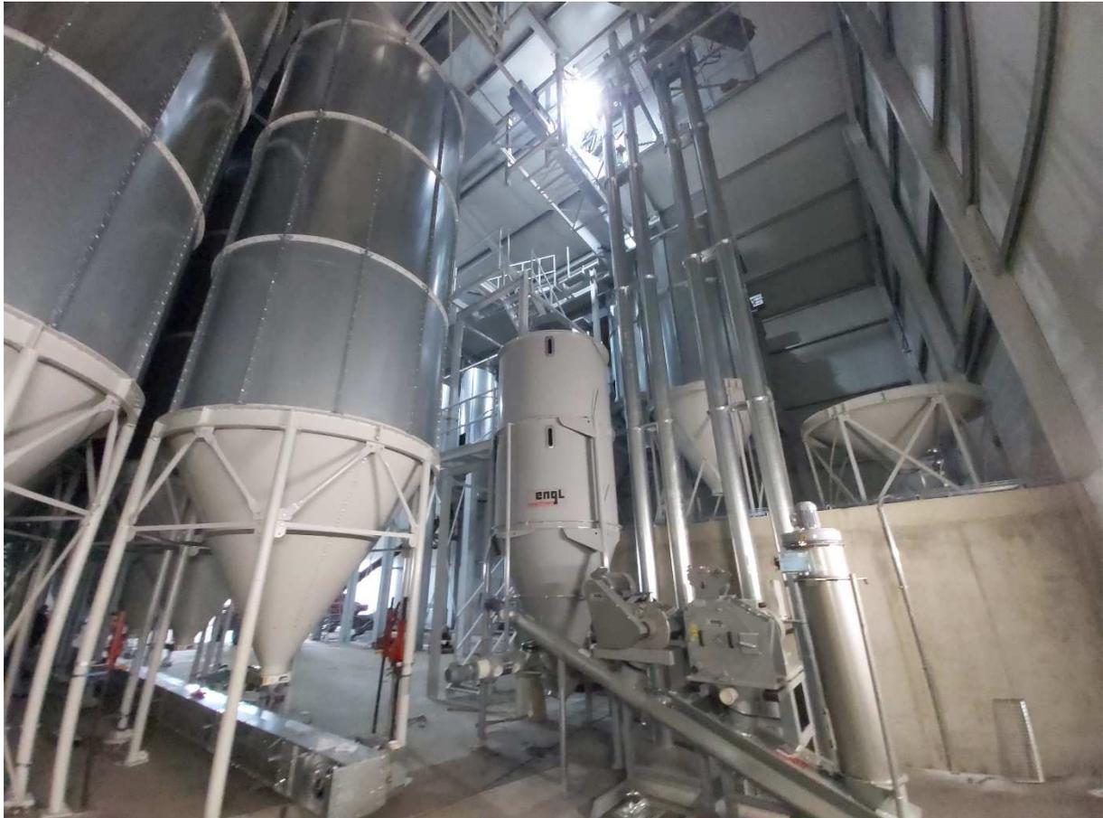
**Stockage pour les matières de densité maximale  $750 \text{ kg/m}^3$
