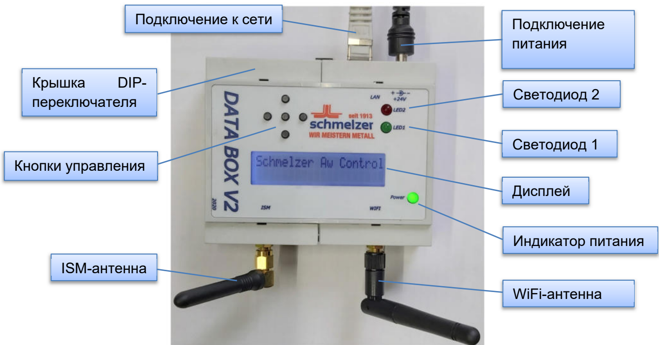
Рисунок 4: Подключённая базовая станция (с помощью сетевого кабеля).
