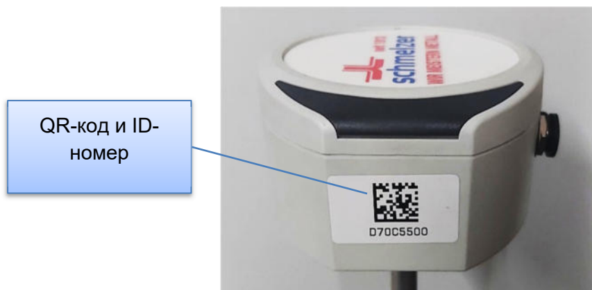
Рисунок 9: ID-номер и QR-код на измерительной штанге
