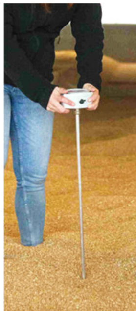
Représentation 19: La tête de mesure doit toujours être placée tout en haut
