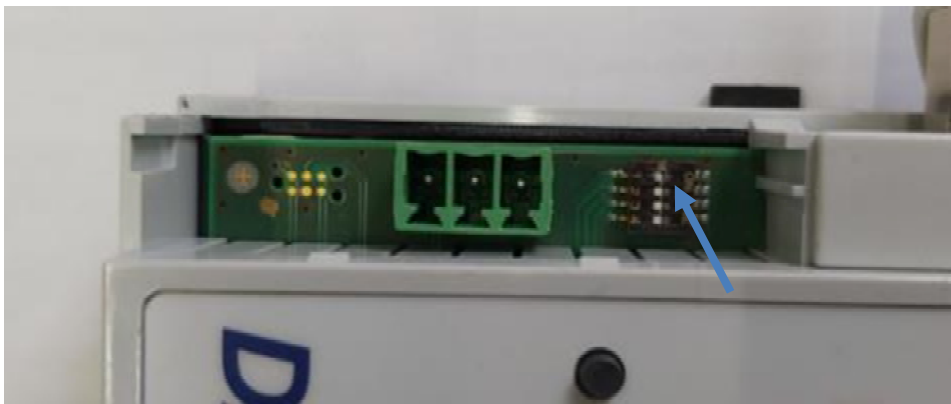
Рисунок 6: DIP-переключатель блока базовой станции. (Настройка локальной сети)
