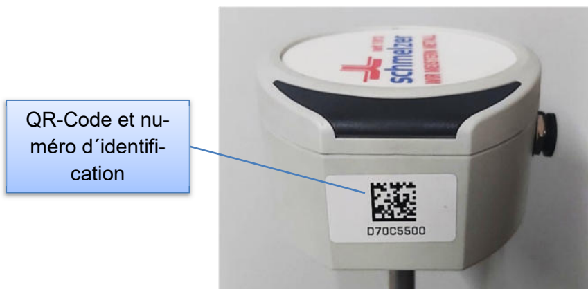
Représentation 7: Numéro d'identification et QR-Code sur la tête de mesure
