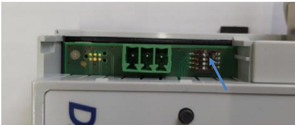
Représentation 4: Interrupteur DIP sur la boîte de collecte des données (configuration LAN).
