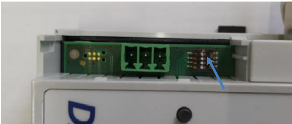
Abbildung 6: DIP Schalter der Datensammelbox. (Einstellung LAN).
