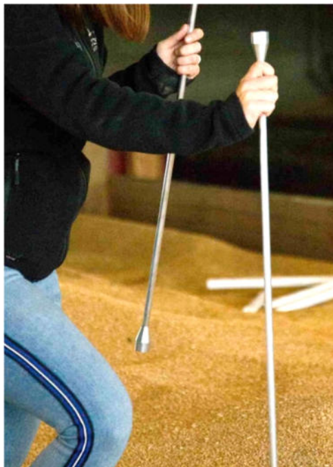
Рисунок 19: Установка удлинителя с наконечником в сыпучий материал.
