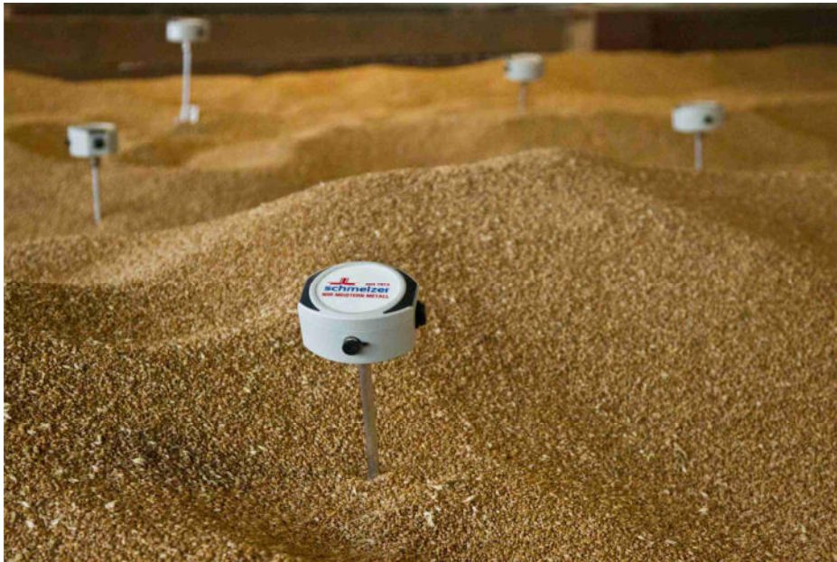
Abbildung 11: Messstäbe eingebracht in Weizen.
