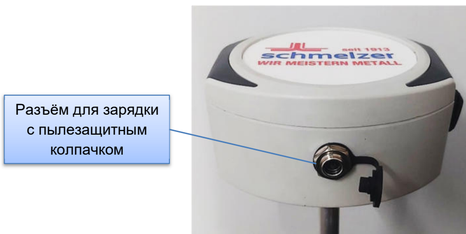
Рисунок 8: Разъём для зарядки постоянным током
