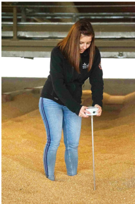
Рисунок 23: Установка измерительной штанги с наконечником в сыпучий материал.
