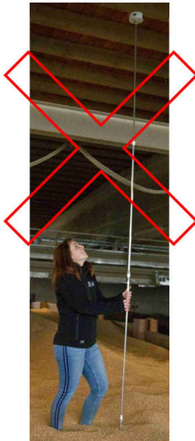
Abbildung 22: Negativbeispiel. Messstäbe immer zerlegen.
