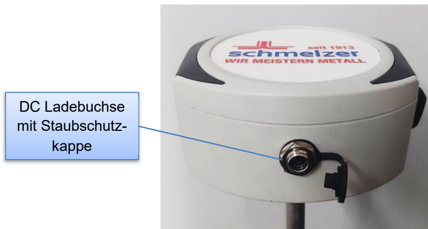
Abbildung 8: Offene DC Ladebuchse.
