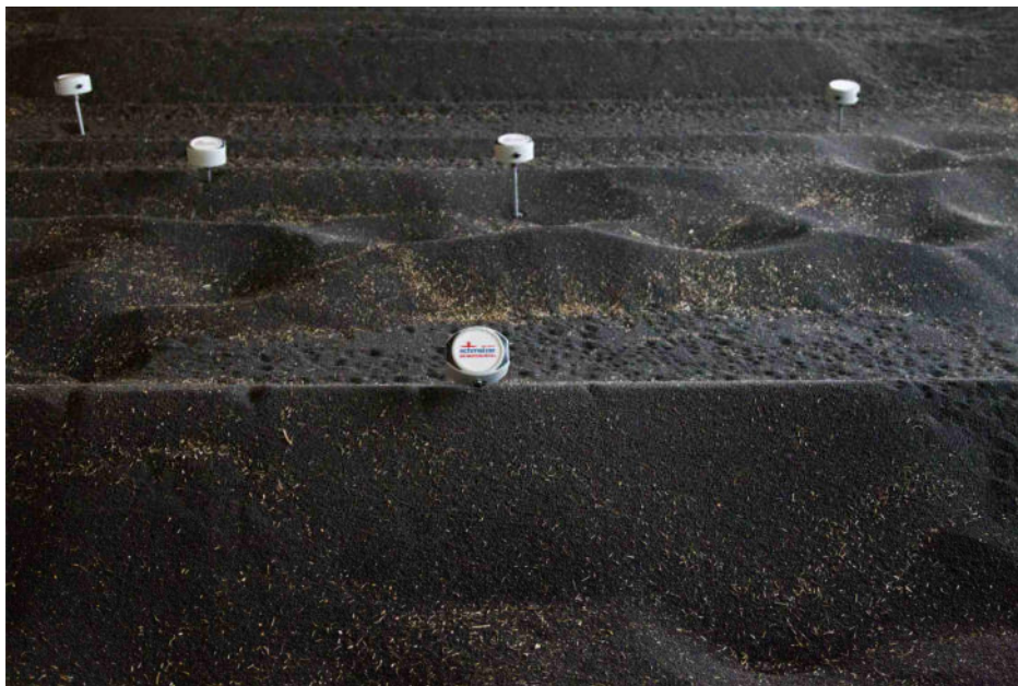
Représentation 8 : têtes de mesure dans le colza
