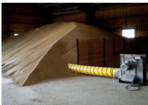
Ventilateur LC sur chassis roulant
