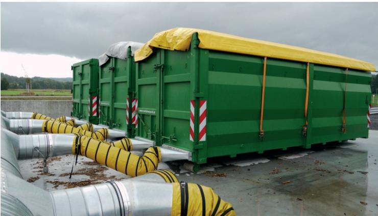
Container de 32 m<sup>2</sup> pour le séchage des céréales et des copeaux de bois
