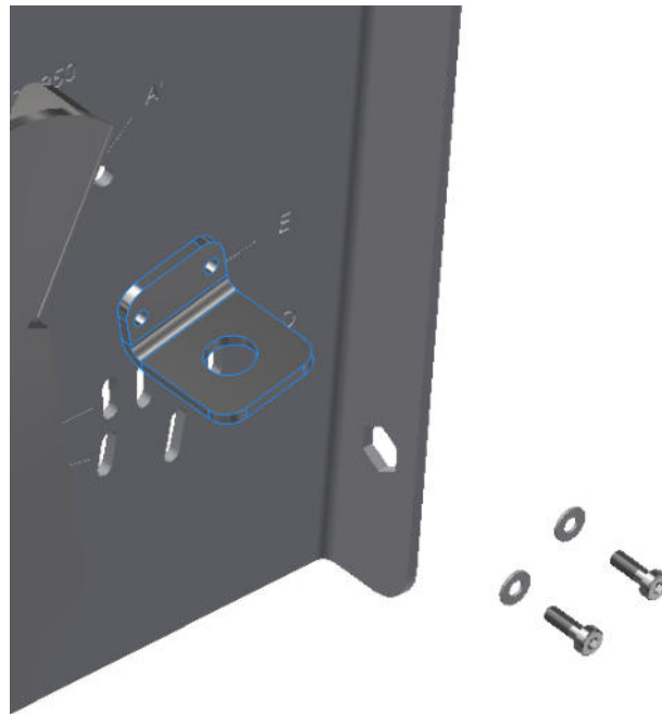
Abbildung 23: Montage des Haltewinkels für induktive Endschalter.
